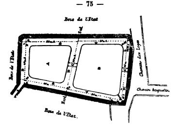
Les fosses alimentés par la *More Baguette* ont été creusés dans une masse d'argile qui ne permettait pas la déperdition de l'eau.
